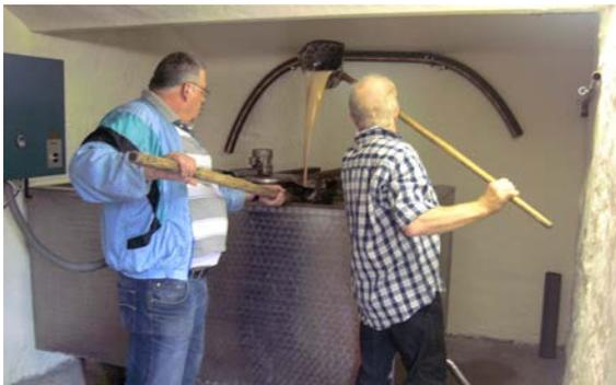
Die für den Brauvorgang benötigte Wärme wird mittels Holzfeuerung erzeugt. Für Kühlung, Antrieb der Transmission und Beleuchtung wird der Strom aus der Fotovoltaikanlage auf dem Dach genutzt. Sechs bis acht Sude mit jeweils ca. 20 hl Bier werden jährlich im Brauhaus gebraut.
